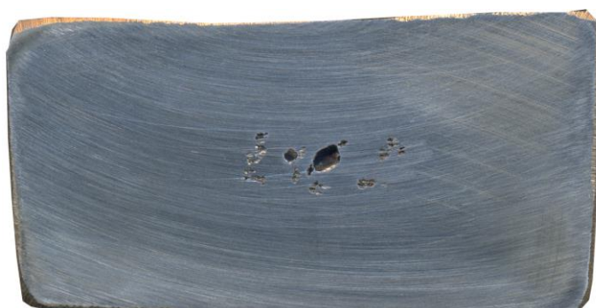
Figura 32 – Rechupe no corte transversal da seção 3 do corpo de prova sem resfriador que recebeu luva exotérmica.
