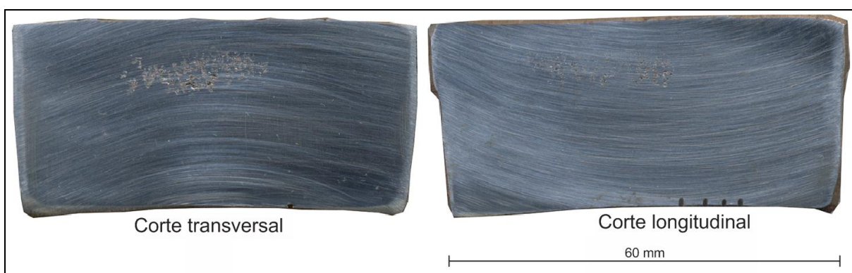
Figura 36 – Rechupe nos cortes transversal e longitudinal da seção 3 do corpo de prova com o resfriador de 651 gramas.
